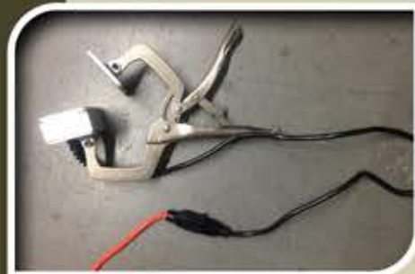
Conecte el Heat Clamp™.
