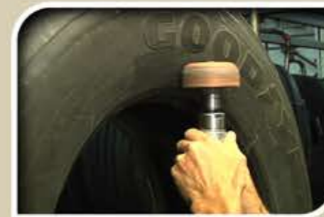
Uso el Motutul a baja velocidad y pula la zona hasta que quede una "textura aterciopelada".
