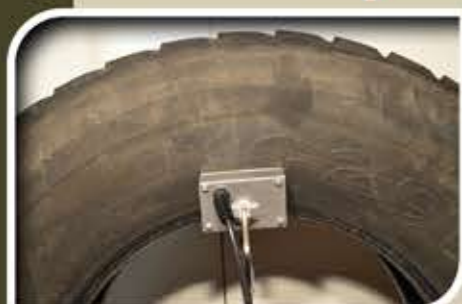
Asegure el HC en la llanta con suficiente presión, requiere el uso de ambas manos. El HeatClamp™ debe de "cuadrar" en la llanta.
