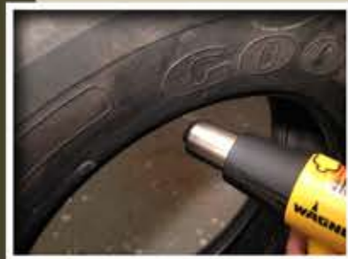
(OPCIONAL) Caliente la llanta por 5 segundos.
